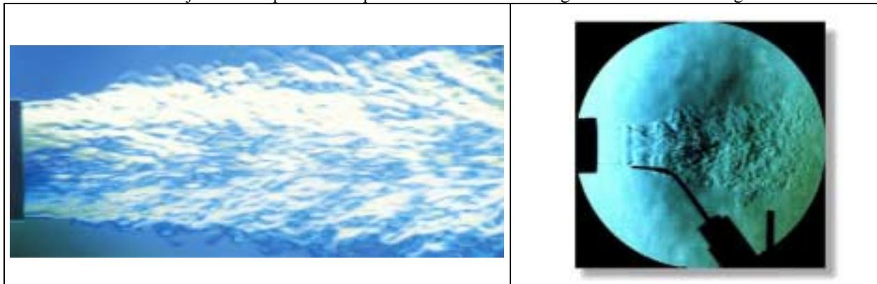
**Figure 4.3 :** Jet de CO<sub>2</sub> (à gauche) et d'un gaz non précisé (à droite) dans de l'air initialement au repos (extrait de [3] et d'un site Internet).
