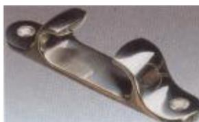
**Chaumard** : ouverture dans le pavois ou pièce d'accastillage fixée en abord du bateau (sur la « lisse ») et servant à guider les amarres vers la bitte ou le taquet.
