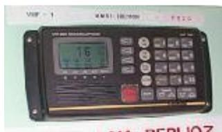
V.H.F. signifie Very High Frequency et est en fait une gamme de fréquence (de l'ordre de 160 MHz) dont le terme est assimilé à l'appareil qui utilise ce type d'onde.
