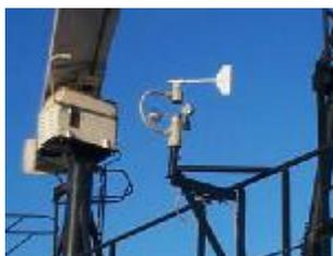
On mesure la vitesse du vent avec un « anémomètre ».
