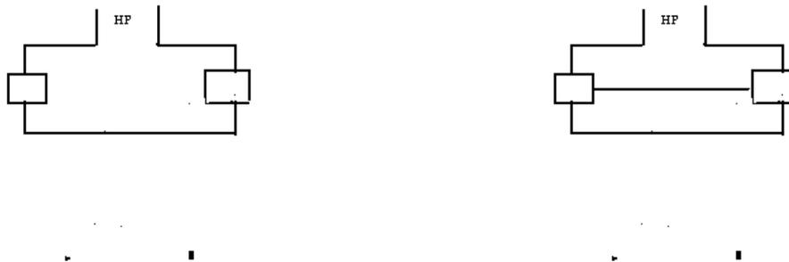
Dans le cas du schéma de gauche, les deux bouchons sont expulsés dès l'ouverture de la haute pression. Dans le cas du schéma de droite, la haute pression est sans influence sur les deux bouchons.
