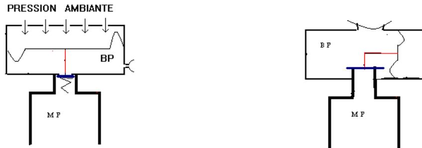
La première génération de détendeur avait installé le clapet du deuxième étage en amont de son siège (schéma de gauche). En cas de défaillance du ressort de moyenne pression du premier étage, cela pouvait provoquer une augmentation continue de la valeur de la moyenne pression et l'éclatement du tuyau reliant les deux étages de détente.
